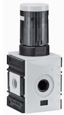
Material: Grivory (PA66) / IXEF1022 Prüfdruck 64 bar = Berstdruck nach ISO 6953
