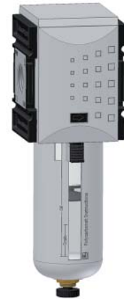
Material: Grivory (PA66) / IXEF1022 Prüfdruck 64 bar = Berstdruck nach ISO 6953
