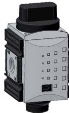
Material: Grivory (PA66) / IXEF1022 Prüfdruck 64 bar = Berstdruck nach ISO 6953
