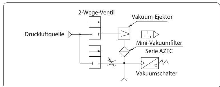
• Anwendung Vakuumpumpensystem
